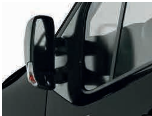
2 GROOTHOEKSPIEGELS met elektrische bediening en geïntegreerde richtingaanwijzers
