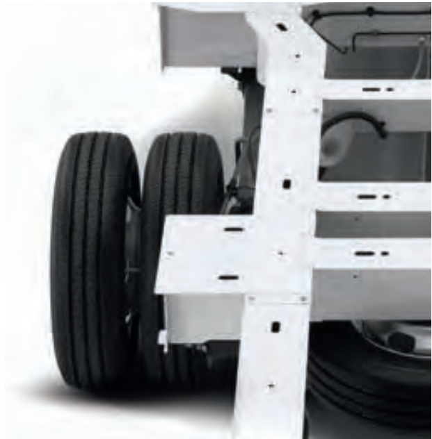
DUBBELLUCHT voor het vervoer van zware lasten
