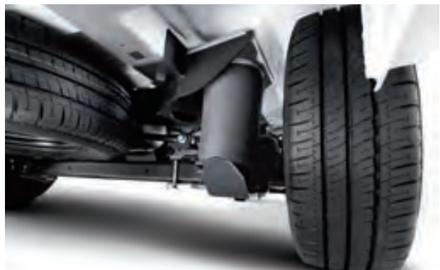
LUCHTVERING* voor een optimaal comfort en handhaving van een constante hoogte, ongeacht de belading
