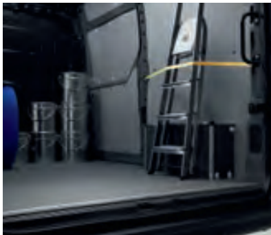
Zijwanden en vloer antislip-polypropyleen 6 mm
