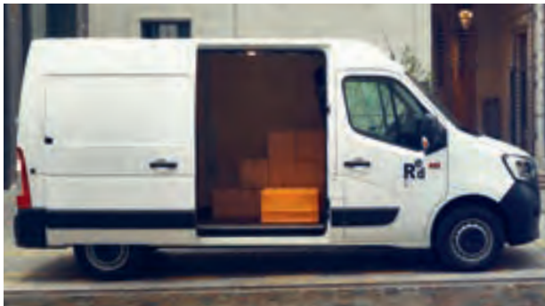
BREDE ZIJSCHUIFDEUR voor het laden van een europalet
