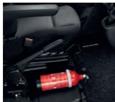
Brandblusser en bevestiging
